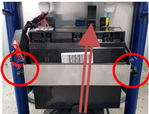
Abb. 7. - Trennen vom Akku aus dem Halter, Lösen von Schrauben und Akku-Halter.
